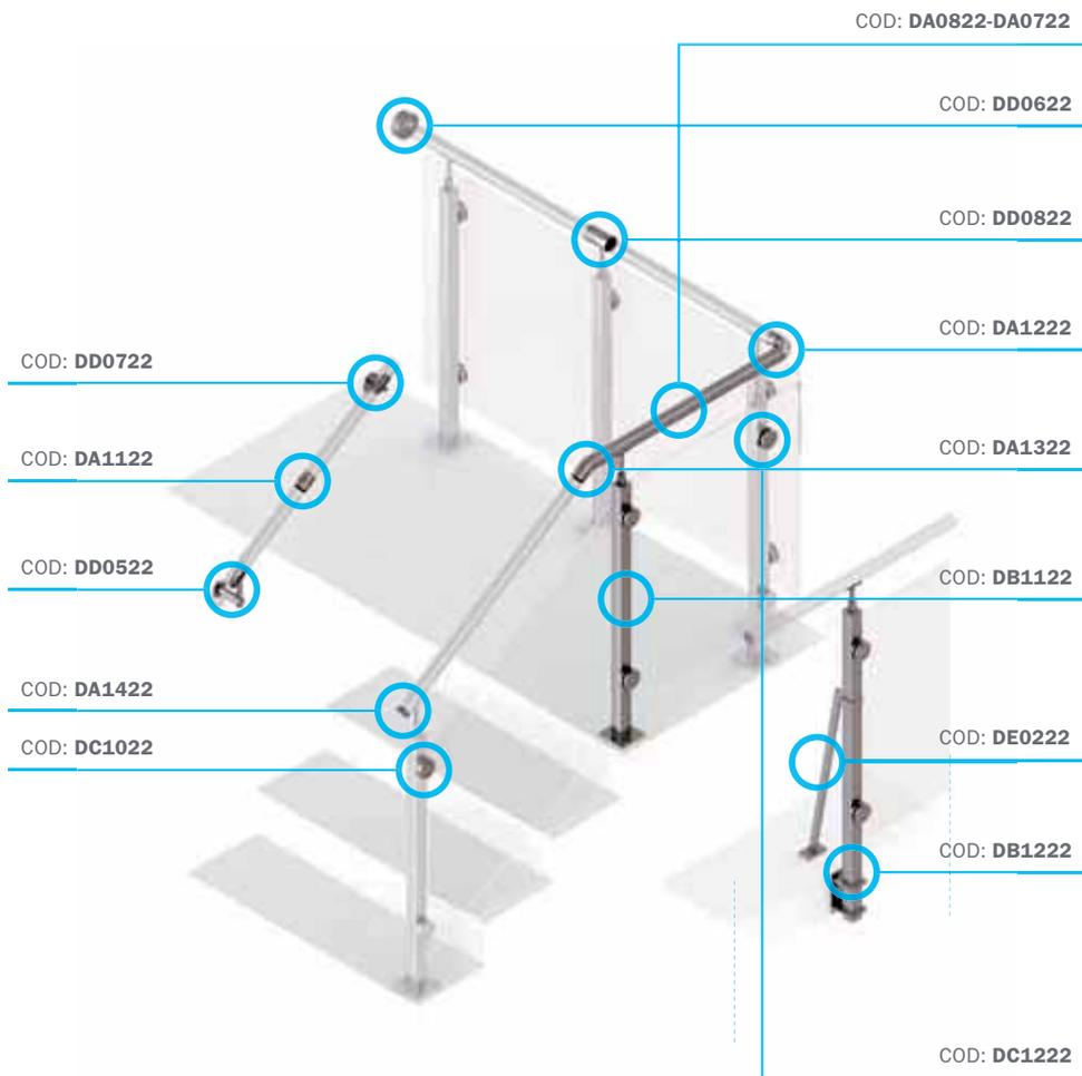
Il montaggio delle ringhiere con pannelli deve avvenire in due tempi. Solo dopo aver installato tutti i componenti in acciaio, si possono prendere le misure per i pannelli. Per l'acquisto rivolgersi ad un fornitore specializzato.
